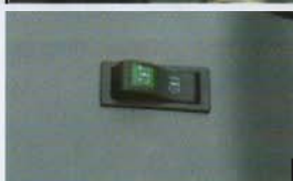
SUL TUNNEL un pulsante comando il passaggio da 2wd a 4wd e viceversa.
