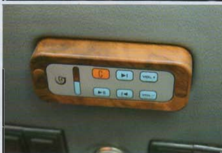
SUL TUNNEL un pulsante comando il passaggio da 2wd a 4wd e viceversa.
