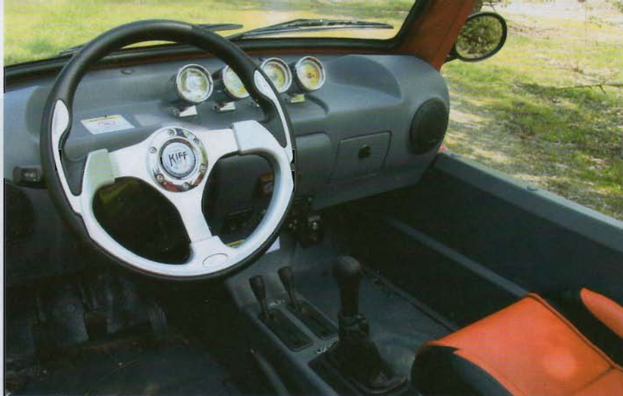
SUL TUNNEL, davanti alla leva del cambio, in posizione pratica, ci sono le due leve per comandare il bloccaggio dei differenziali. Notare la strumentazione con 4 elementi circolari disassata rispetto al posto di guida. Il piccolo display in simil radica è quello dell'impianto audio e della radio.
